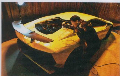
暗幕で囲われたブース内に多様な色の光源が備えられた研磨スペース。光源を活かすことで、かすかなキズも見逃さずに研磨することができる。コーティング作業の要だ。
