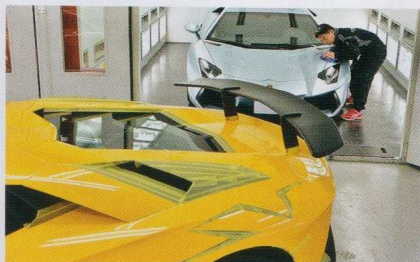
ファイナライズ処理設備は、コーティングの施工場所としても使用している。施工後、クルマを動かすことなく硬化させるため、ホコリの混入を許さないなどメリットは多い。
