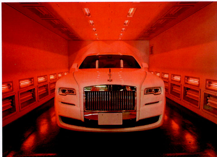
カービューティーマックスが特許を持つファイナライズ処理設備。コーティング施工後、部分的に硬化させるのではなく全体を一気に硬化させることで、完全硬化を実現する。
