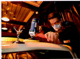
研磨作業は遮光カーテンで仕切られたブース内で行い、キズを浮きだすために多彩な光源も完備。ポリッシャーも作業性を考慮した特別仕様だ。
