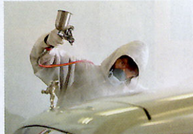
ファイナライズ処理設備内でコーティング施工は行われるので、ホコリ付着の危険性もない。また作業者は防護服やゴーグル着用で作業者の健康も心がけている。
