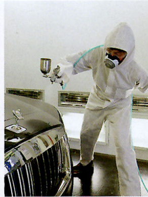
←きれいに磨き上げた後はファイナライズ処理設備内でコーティング施工。その後はクルマを移動することなくファイナライズ処理を施すのでホコリの心配もない。 ↑濃色車では見えにくいキズも見つけて磨き上げられるようブラックブースを設置。また光源も多彩なので完璧な磨きが可能だ。
