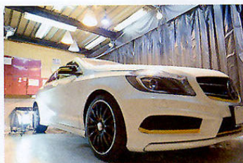
遮光カーテンで囲われいろいろな光源でキズを徹底的に見つけることができる独自開発のブラックブース。キズを徹底的に処理することがコーティングでは重要なだけに必需品になっている。
