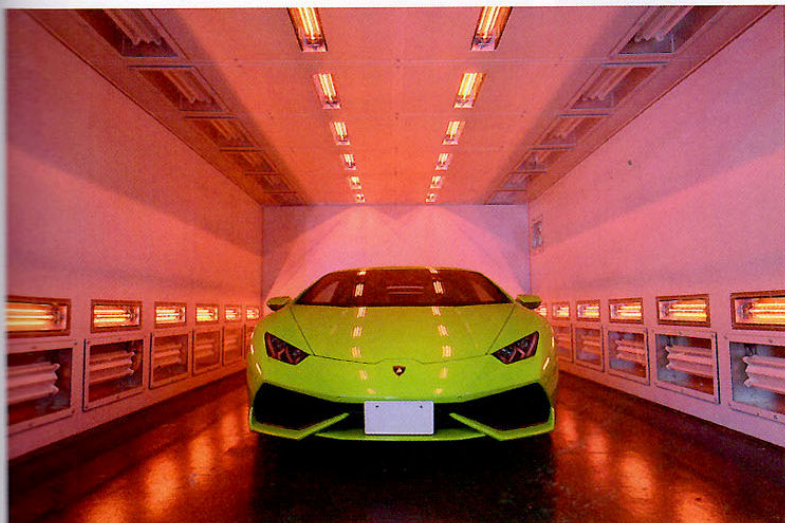
通常、施工後1ヵ月ほど掛かる被膜の完全硬化を納車前に行えるファイナライズ処理設備。ホコリの心配もないため究極のコーティングには欠かせない設備である。
