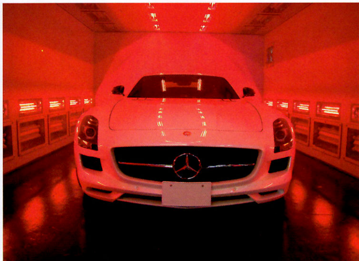
コーティングは、施工後すぐにファイナライズ処理を行うことにより皮膜を完全硬化させる。究極のコーティング施術には必須の設備だ。
