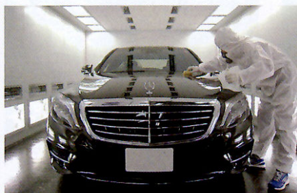
コーティング施工において、重要となるのが防塵。外部と遮断できるファイナライズ処理設備内でコーティング施工が行われる。
