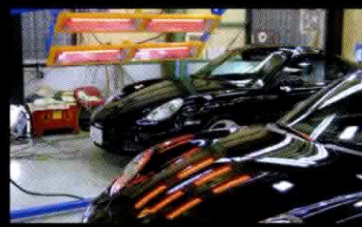
遠赤外線焼付器を設置。コーティングの効果を飛躍的に持続させます。
