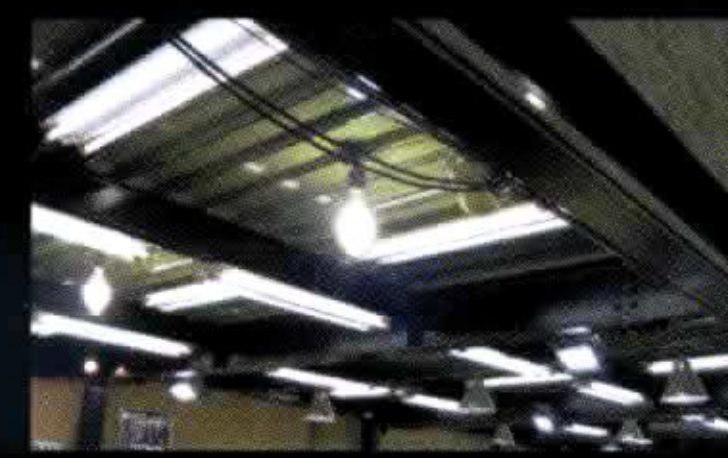
塗装の細かな傷を見極める為の様々な照明環境。
