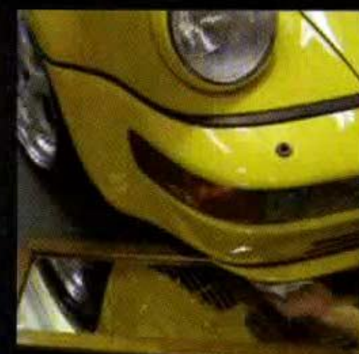
ミラーを使い目の届かない箇所も施工
